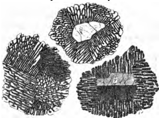
Fig. 24. Micropegmatites auréolées. (Lame mince de la micropegmatite de Calésima (Corse). En haut, un grain de quartz (Q) est entouré d'une auréole de micropegmatite d'orthose et de quartz, dont le quartz est orienté comme le grain central (le feldspath a été éteint). A droite en bas, c'est l'inverse qui se produit : le feldspath de l'auréole est orienté comme le cristal de feldspath central (F). A gauche en bas, micropegmatite dépourvue de cristal central.
